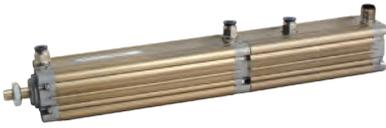
Das System benötigt keine Verbindung mit dem beweglichen Teil des Mechanismus, da die Bewegung durch einen internen Kolben mit bidirektioneller pneumatischer Funktion selbst erzeugt wird. Dieser Kolben bewegt sich über die Betätigung eines 5-Wege Ventils autonom bis er auf das Hindernis stößt und folglich die Feststellposition misst.
